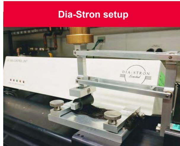
Dia-Stron MTT175 Tensile Tester
